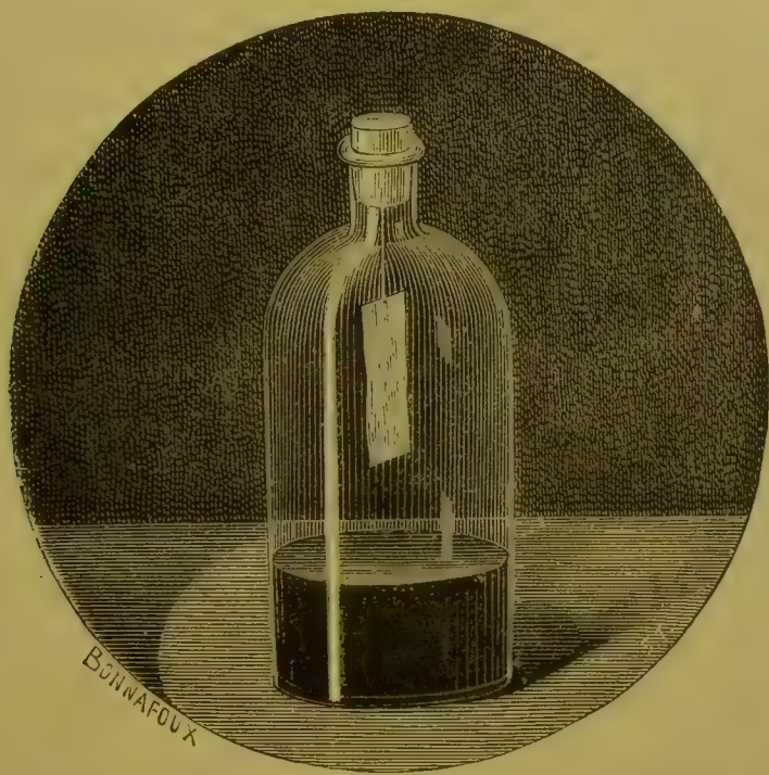
Fig. 214. Foglia d'oro esposta ai vapori di mercurio.
